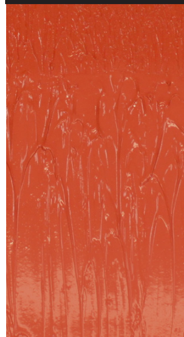
APPLICAZIONE CON RULLO A PELO LUNGO
