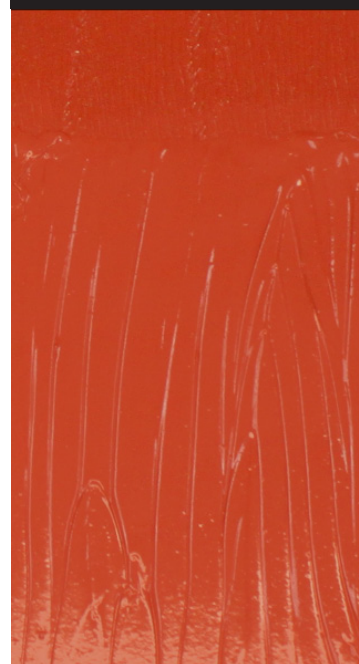
APPLICAZIONE CON RULLO DI SPUGNA
